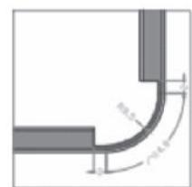
Procesul de curbare (roluire) poate fi realizat utilizând o presă hidraulică sau o mașină de roluit (Figura 1). ExalcoBond-ul poate fi curbat până la o rază minimă egală cu de 15 ori grosimea panelului (Figura 2). Se recomandă utilizarea unor masini de roluit cu 3 valțuri reglabile, cu dimensiuni variate, pentru a putea acoperi o gamă cât mai variată de curburi necesare realizării de virole cilindrice sau tronconice.
